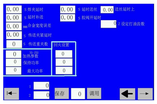
焊夹延时: 传送夹与焊夹交接合金时焊夹夹紧的时间;
