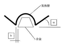
9) 光纤位置调节。光纤光束从后面的传感器发出,被前面的传感器接收,发射器与接收器交替转换,光束穿过发热管,尽量靠近锯片齿基,旋转中锯片与刀头间隙应大于0.5mm,水平调节锯片位置使锯片齿基与合金间隙在0.2~0.5mm。按旋转按钮查看并调节锯片转后是否停在正确位置(可通过调间隙1来调节其位置);
