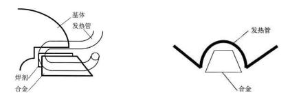
发热管形状: 热量先在基体齿基底部产生,因为在此处的线圈较密,但是测温点却在基体外缘处,如果加热过快,就会导致测温点达到设置温度时齿基处温度却过热(如图①),可以通过改变发热管的形状来避免此现象的发生,在垂直方向(纵向)上使线圈打开更大些,会使热密度减小,这样会使基体与合金的温度更加平均(如图②),如果发热管上部打开些,线圈的热量传导会更加集中(如图③)。
