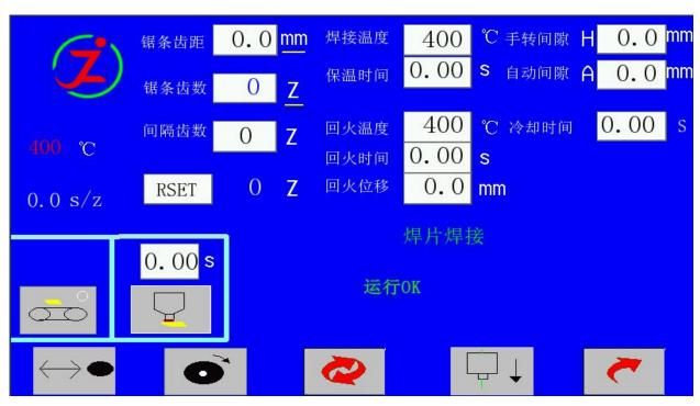
**锯条齿距**:每次焊接一种规格锯条时要输入相应的锯条齿距数值,否则影响机器工作定位。
