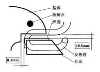
10) 红外线测温仪的调整。焊接温度的测量点在基体上合金附近处(外缘),如果发热管 后面的弯曲离合金太近,就会使合金上的焊剂沾到发热管上;焊剂太多就会影响到高 温传感器的测量结果,这会导致高频发生器超过设置好的焊接温度而使基体过热。
